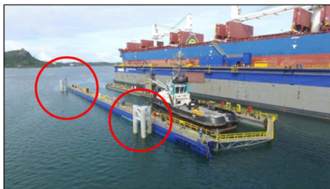
Ilustración 2. Sistema de amarre en zona de aguas profundas.
